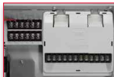
Конфигурация на 16 станций с модулями по (1) 12 станций
