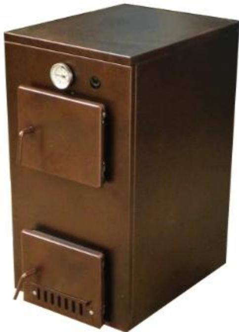
У этих типов котлов все основные узлы теплообменника изготавливаются из высокопрочной, холоднокатаной стали толщиной не менее 3 мм, что значительно продлевает срок службы котла. Сварка котлов производится на полуавтоматических сварочных машинах в среде CO<sub>2</sub> итальянского и финского производителей.
